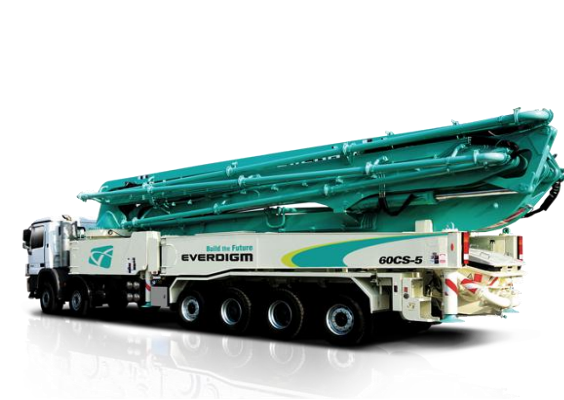
Xe bơm bê tông
